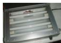
Belichtungsgerät mit UV-Leuchtstofflampen
