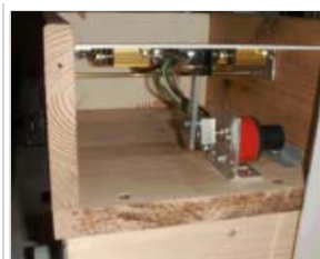
Selbstgebaute Schalenätzanlage (Seitenansicht, Blick in die geöffnete Maschine)
