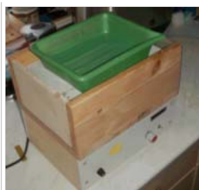
Selbstgebaute Schalenätzanlage (Aufsicht)
