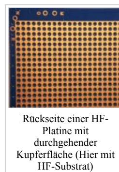
Vorderseite einer HF-Platine mit Punktraster (Hier mit HF-Substrat)
